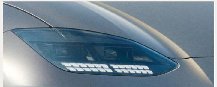
**Leuchtendes Vorbild.** Die intelligenten Matrix-LED-Scheinwerfer des neuen IONIQ 6 sorgen für optimale Sicht und verhindern durch eine automatische Erkennung des Gegenverkehrs und Ausblendung einzelner LED-Module, dass andere Verkehrsteilnehmer geblendet werden.
